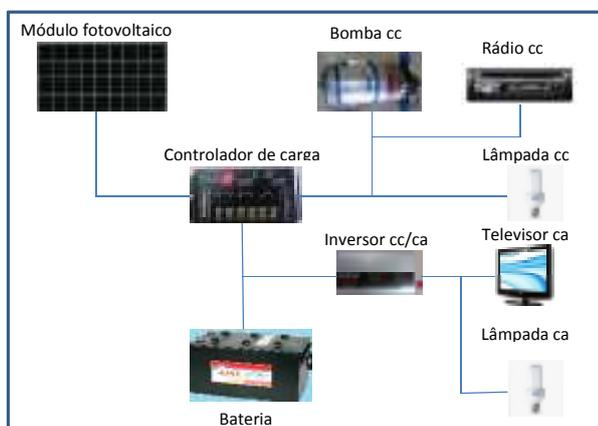
Sistema fotovoltaico com baterias
