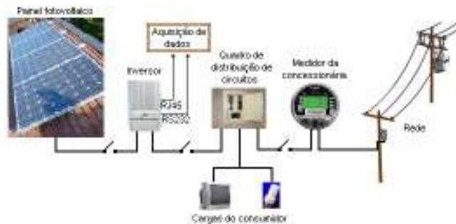
Sistema fotovoltaico conectado à rede
