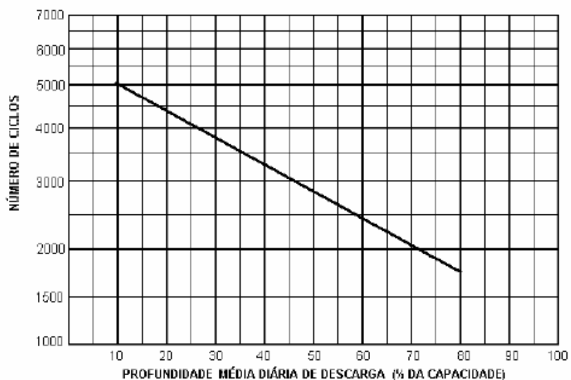
FIGURA 03 – GRÁFICO DA RELAÇÃO ENTRE A PROFUNDIDADE MÉDIA DE DESCARGA DURANTE UM CICLO E O NÚMERO DE CICLOS FONTE:(ROSEMBACK, 2004)
