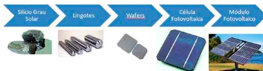
Figura 9 Etapas de produção do módulo fotovoltaico a partir do silício cristalino Fonte: ABINEE (2012)
