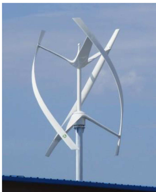
FIGURA 8- Aerogerador Eixo Vertical (DUARTE, 2010, p.33)
