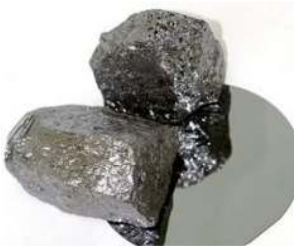
FIGURA 2 - Silício grau metalúrgico. [Imagem: Ag.USP] Fonte: http://energiasollar.blogspot.com.br/2010/07/brasil-quer-criar-tecnica-para-produzir.html
