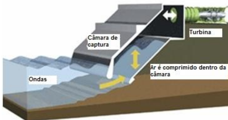
Figura 7.14: Esquema de funcionamento do LIMPET 500. 29
