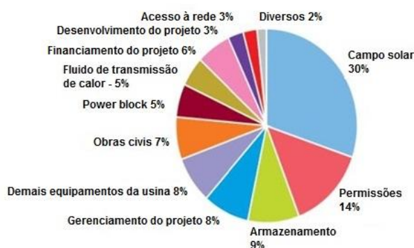
Figura 9.15: Custos de investimento de uma planta CSP de calhas parabólicas de 50MW com armazenamento de 7 horas.
