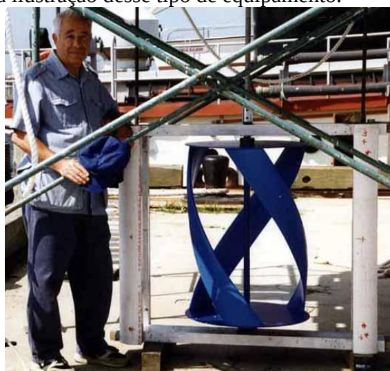
Figura 7.9: Turbina helicoidal Gorlov e seu criador, Dr. Gorlov. 17
