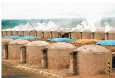
Figura 13.4: Fornos de carvão para a produção de “aço verde”. 16
