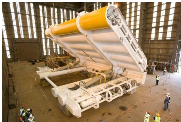
Figura 7.15: Unidade Oyster antes de ser instalada no leito oceânico. 31
